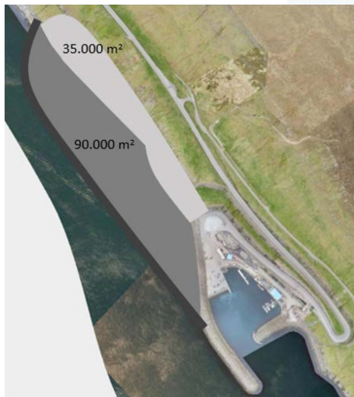
MYND 6: ÚTBYGGING AV GOMLURÆTT TIL NÝTT 125.000 M 2 VINNUØKI.
