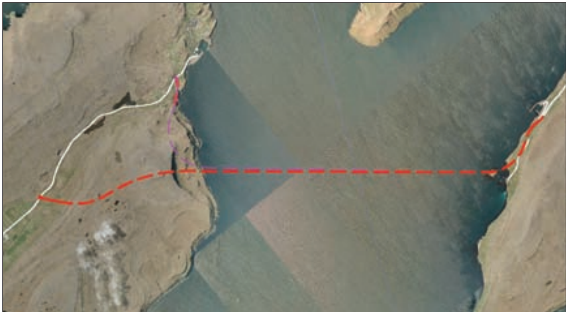
MYND 6.30: TUNNILIN MILLUM SANDOY OG STREYMOY VERÐUR AV GOMLURÆTT TIL TRADARDAL Á SANDOYNNI; REYÐ LINJA. ÖNNUR VIÐGJØRD LOYSN ER FÁA TUNNILIN UPP Í SKOPUN; LJÓSAREYÐ LINJA
