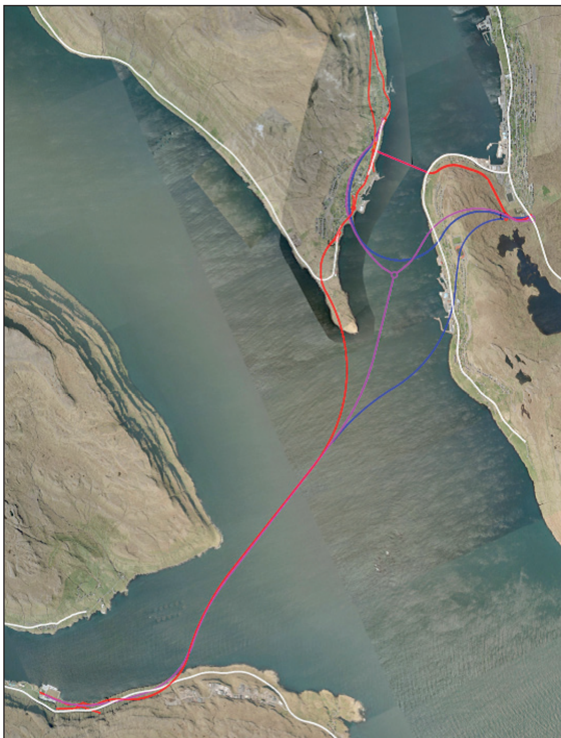
MYND 6.17: LINJUFØRINGAR. HVÍT LINJA ER VERANDI FARLEIÐ, REYÐ LINJA ER TILMÆLD LOYSN, BLÁ LINJA ER ALTERNATIV LOYSN HJÁ LANDSVERKI VIÐ TUNLI UM SKÁLAFJØRÐIN, OG LILLA LINJA ER LOYSN HJÁ P/F SKÁLAFJARÐARTUNLINUM VIÐ RUNDKOYRING
