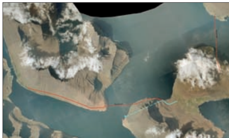
MYND 6.1: LINJUFØRINGAR. REYÐ LINJA ER VALD LOYSN, OG BLÁ LINJA ER FERJULEGA Í HAVN OG TUNNIL TIL BYGDINA
