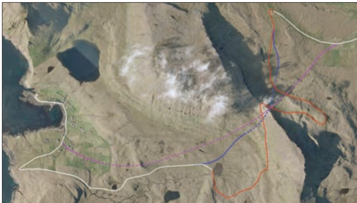
MYND 6.37A: LINJUFØRINGAR Á FARLEIÐINI TIL FÁMJINS. HVÍTA LINJAN ER VERANDI FARLEIÐ. REYÐ LINJA ER VALD LOYSN OG VÍSIR LINJUFØRINGAR. HAR VERANDI VEGUR ER OMAN FYRI 100 M HÆDD. HESIN VEGATEINUR HEVUR STØRST TØRV Á DAGFØRING. EISINI TÁ HUGSAÐ VERÐUR UM KAVA OG LOP. BLÁ OG LILLA LINJA ERU TUNNILSLOYSNIR. BLÁA LINJAN ER TANN STUTTA TUNNILSLOYSNIN, SUM IKKI FER UNDIR 100 M Í HÆDD. LILLA LINJA ER UNDIR 100 M Í HÆDD
