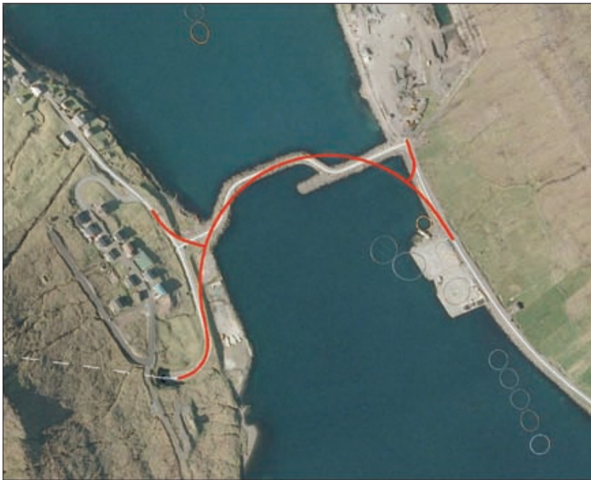
MYND 6.4: LINJUFØRING VIÐ HARALDSUND. ÆTLANIN ER AT DAGFØRA VEG OG BYRGING, SUM REYÐA LINJAN VÍSIR
