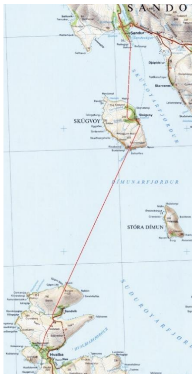
Mynd 2.3: Tunnillin umvegis Skúgvoy. Tann norðari tunnulin er umleið 9 km langur, og tann sunnari er umleið 17,2 km langur.
