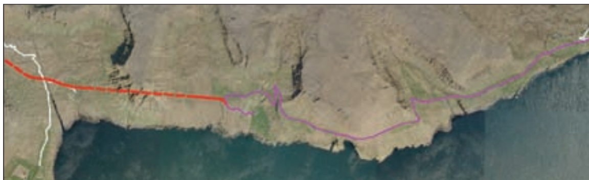
MYND 6.23: VERANDI VEGUR MILLUM SYÐRADALS OG VELBASTAÐAR ER GÓÐAR 7 KILOMETRAR TIL LONGÐAR; LILLA LINJA. TUNNILIN TIL NORÐADALS VERÐUR UM 1.600 METRAR LANGUR; REYÐ BROTIN LINJA. Á MYNDINI SÆST BYRJANIN AV TUNLI ÍMILLUM NORÐRADALS OG KALDBAKSBOTNS (UTTAST T.V.)
