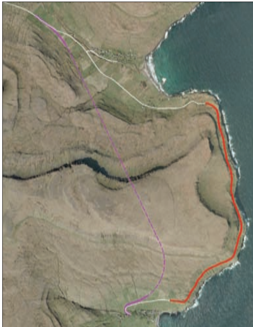
MYND 6.33: HVÍT LINJA ER VERANDI VEGUR, REYÐ LINJA ER VALD LOYSN, OG LILLA LINJA ER TUNNILSLOYSN. TUNNILIN VERÐUR UMLEIÐ 3.060 METRAR LANGUR
