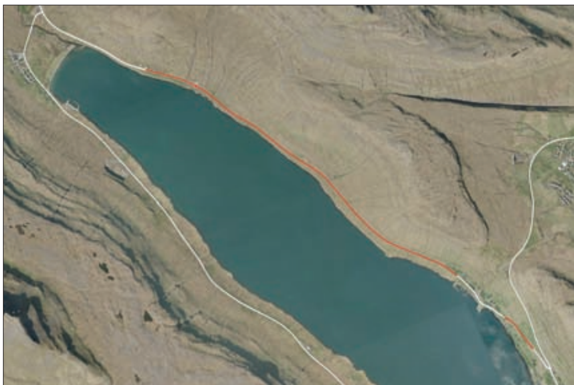
MYND 6.10: LINJUFØRINGAR. HVÍT LINJA ER VERANDI FARLEIÐ, OG REYÐ LINJA VÍSIR TEININ, HAR VEGURIN ER ÖV SMALUR
