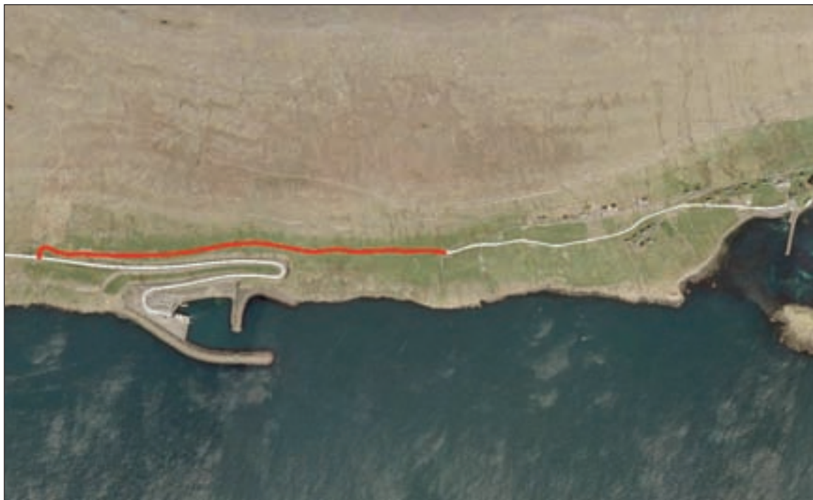
MYND 6.26: LINJUFØRINGAR. HVÍT LINJA ER VERANDI FARLEIÐ, REYÐ LINJA ER VEGATEINURIN, SUM ÆTLANIN ER AT DAGFØRA
