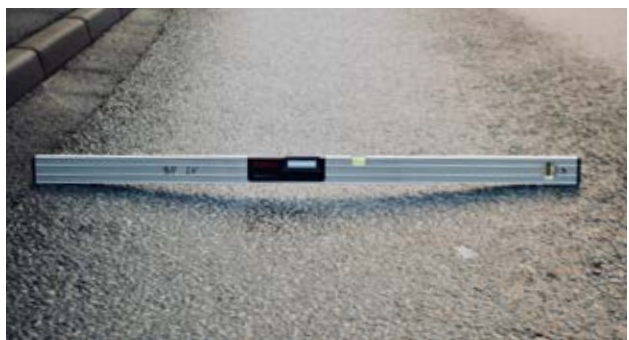
Mynd 1: Á myndini sæst, hvussu sporslit hefur gjørt um seg.
