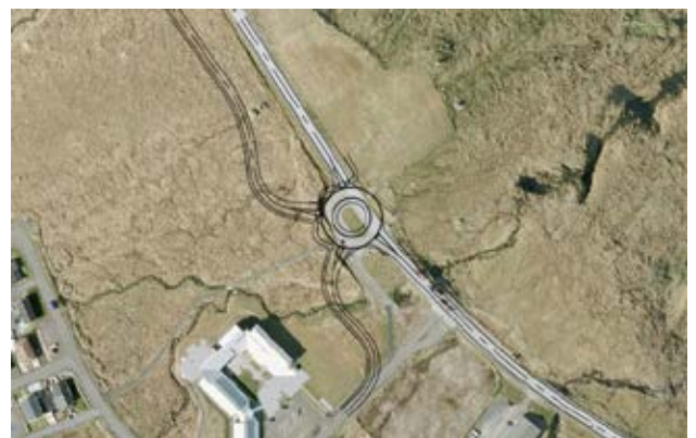
Kambsdalur: Umbygging av T-vegamóti til rundkoyring. Her kann ein minking væntast á 80 % í ferðsluóhappum við fólkaskaða 8 .
